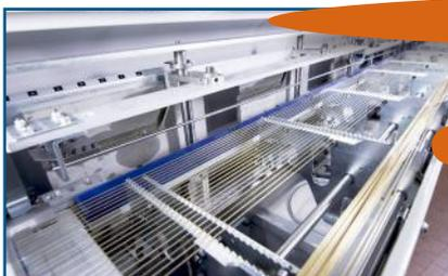
Накопитель пошаговой подачи идеален для загрузки очень тонких прутков. Он гарантирует **повышенную автономность** прутков для обработки на загрузчике.
