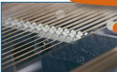
Система **выбора** прутков очень точна и позволяет выбор прутков **0,8 мм** с максимальной надёжностью.
