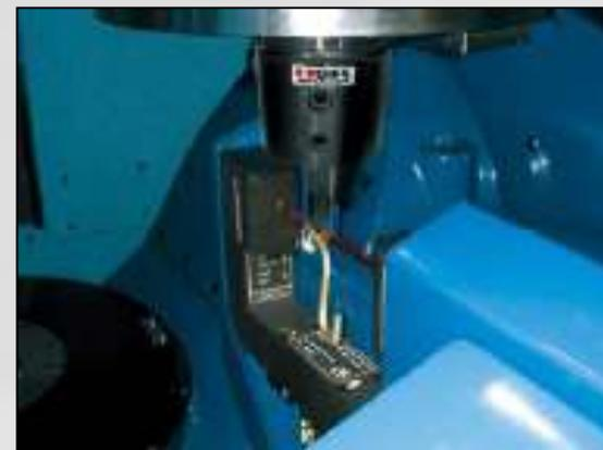
Обнаружение поломки инструмента/
