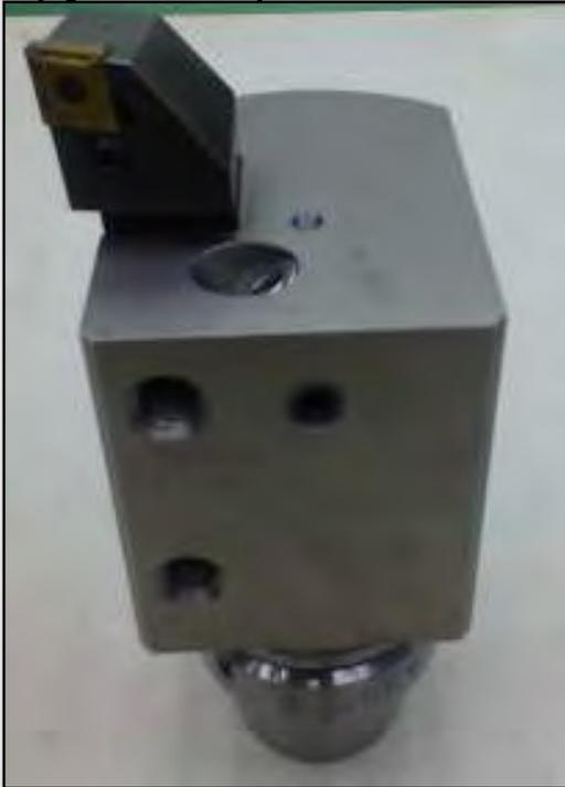
Инструмент, вращающийся против часовой стрелки, для обработки наружной кромки
