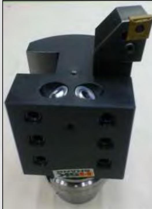
Инструмент, вращающийся по часовой стрелке, для обработки внутреннего диаметра
