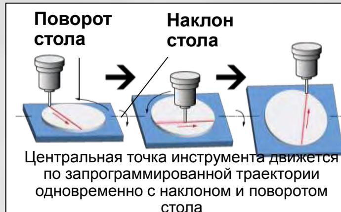
Автоматический контроль траектории движения инструмента/ скорости инструмента
