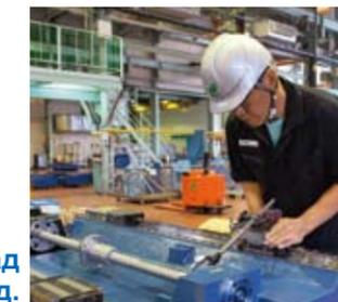
· Для поддержания высокой точности в течение всего срока службы станка, параллельность и прямолинейность настроены с погрешностью в 2 микрона по всему ходу оси в ходе обработки.
