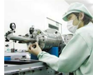
· Все работы над шпинделем Matsuura проводятся в условиях чистой комнаты для обеспечения надежности и соответствия высочайшим стандартам качества сборки.
