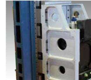
· На пиноли расположены три ребра жесткости, обеспечивающие максимальную жесткость по оси Z.
