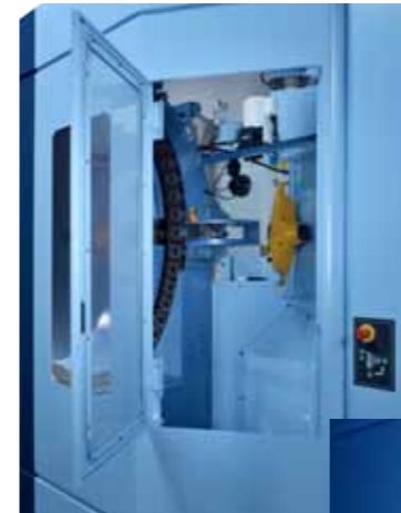
Передняя дверь АСИ обеспечивает легкий доступ для технического обслуживания.
