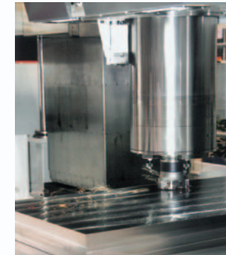
Вертикальный шпиндель (стандартный) макс. мощность резки 22 кВт
