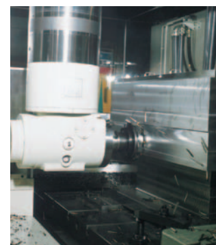
Угловая накладная головка (стандартная) макс. мощность 22 кВт
