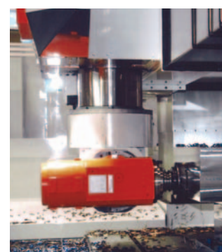
90-градусная универсальная накладная головка (опция) макс. мощность резки 15 кВт
