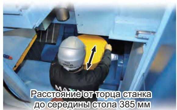
Расстояние от торца станка до середины стола 385 мм
