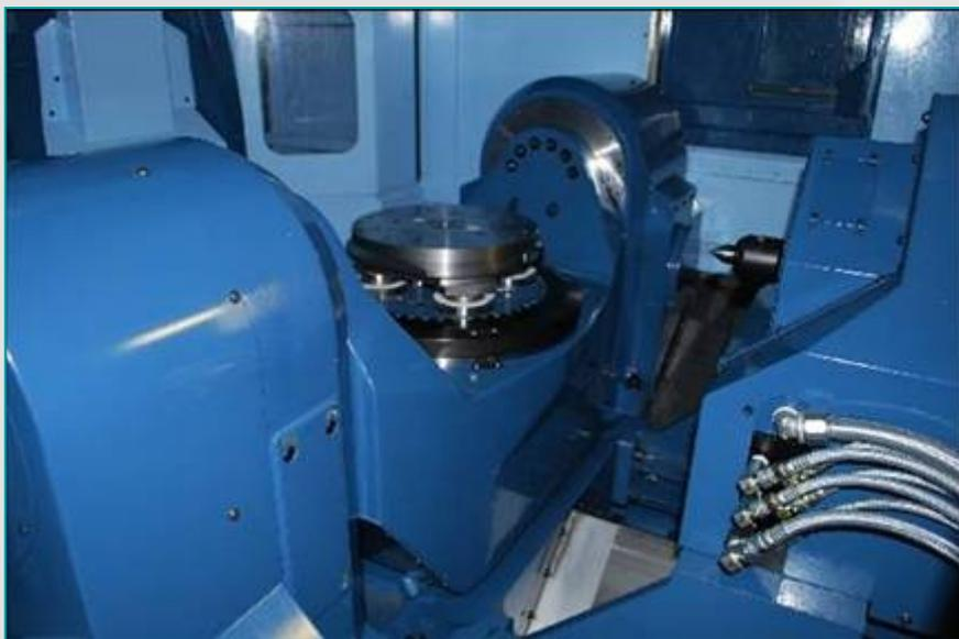
Двигатель прямого привода по оси С
