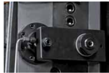
Ось W оснащена двухконтурным гидравлическим балансировочным цилиндром для блокировки оси на полном ходу вне зависимости от ее местоположения.
