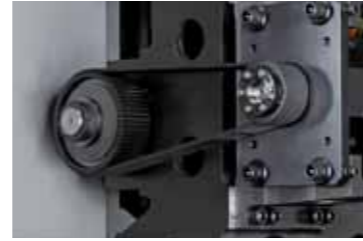
Сервоприводы осей X, Z и W оснащены защитным механизмом ограничения крутящего момента.
