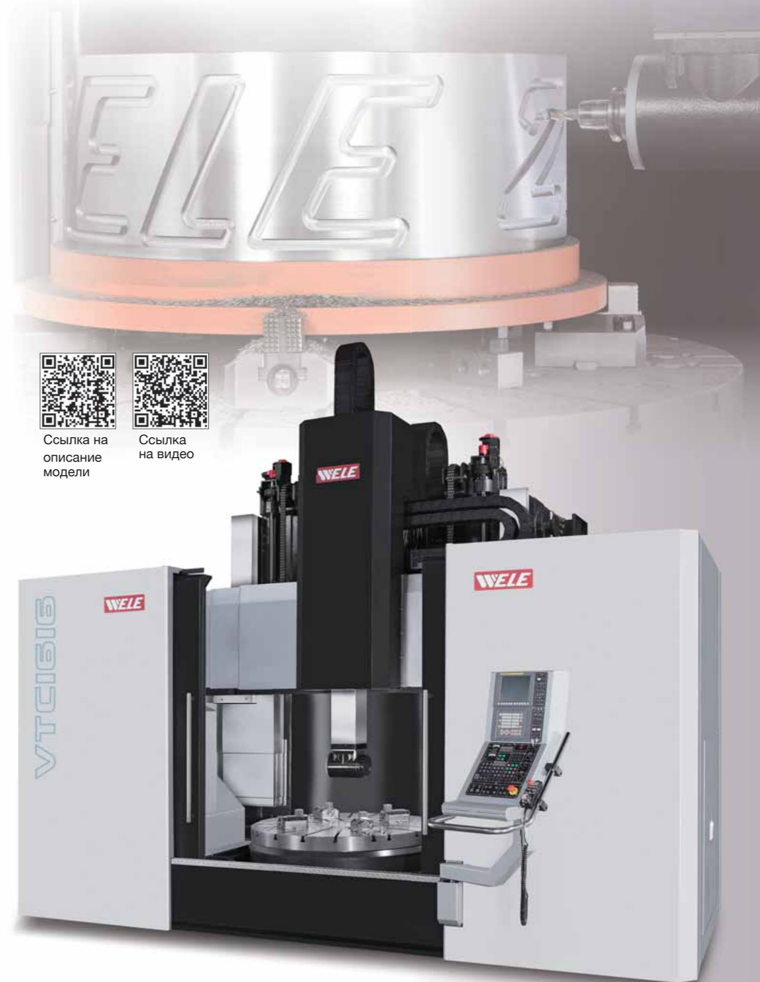
На иллюстрации изображен станок VTC 1616 с угловой фрезерной головкой жесткого зацепления и герметичным ограждением рабочей зоны.
