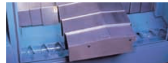
Шнековые конвейеры для удаления стружки (с правой и левой стороны)
