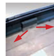
Стружкоотвод с передней стороны оси Y
