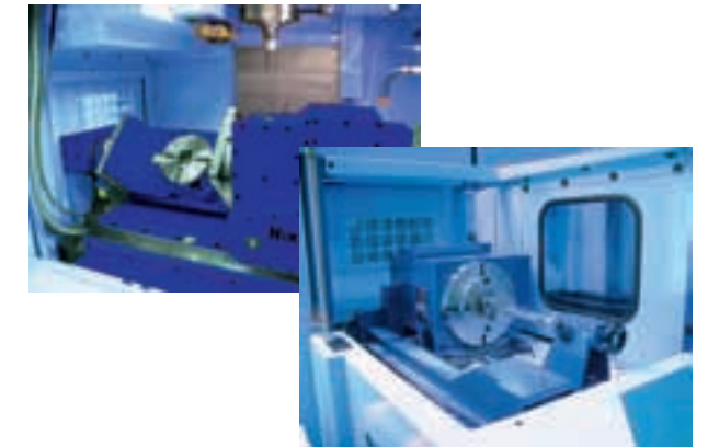
Примеры наклонно-поворотных столов
